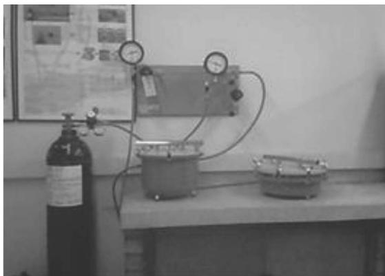
Figura 2. Montaje para la medición de las propiedades de liberación
