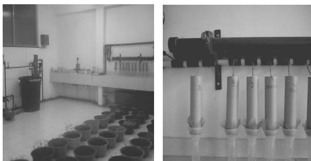
Figura 4. Montaje para la medición de la retención ante irrigación instantánea
